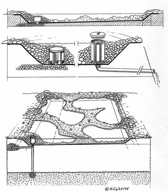
Skizzen zum Bau von astatischen Foliengewässern mit verschiedenen Anordnungen von Abflussrohren
