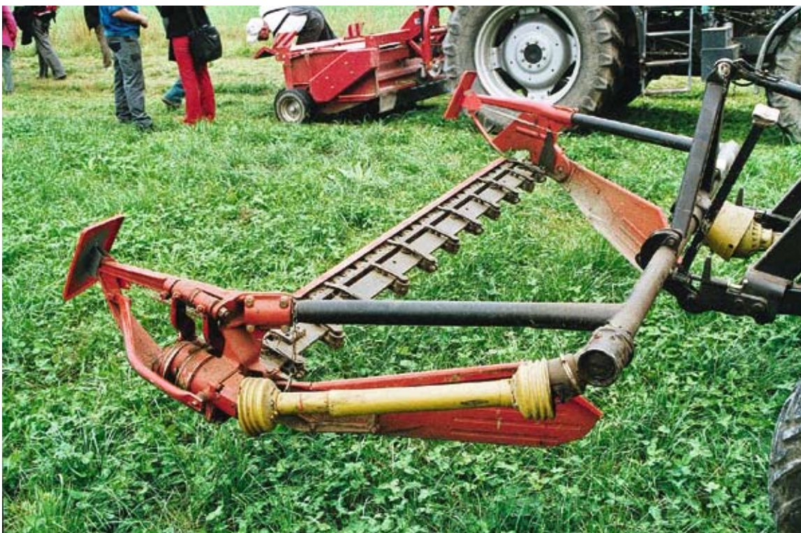
Messerbalkenmäherwerke sind hangtauglich und artenschonend. Die Mähleistung ist im Vergleich zum Kreiselmäher kleiner und der Wartungsaufwand rund 5-mal höher.
