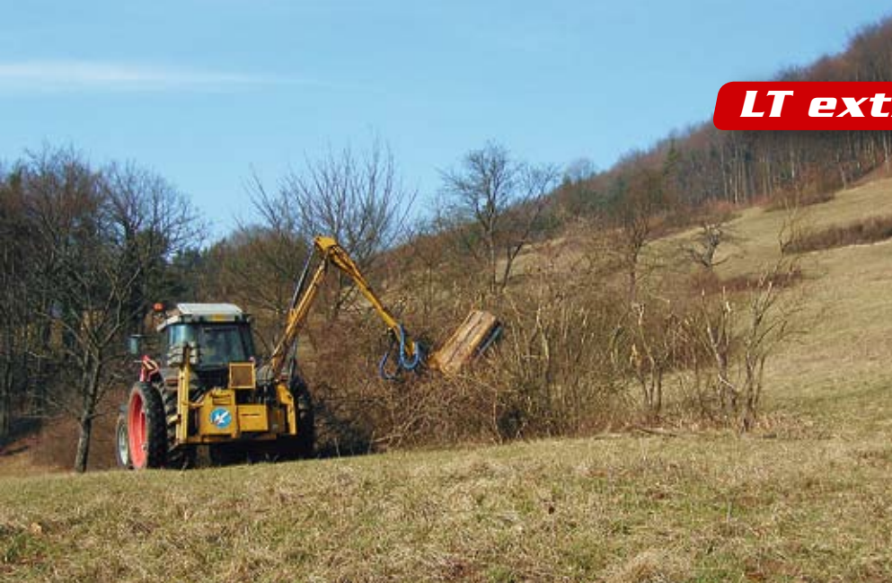
Die Heckenpflege mit Motorsäge und Durchforstungsschere ist sehr arbeitsaufwändig. Sie wird deshalb vermehrt mit Schlegelmulchern für die Böschungspflege durchgeführt. Das Abschleppen von Niederhecken darf nur während der Vegetationsruhe ausgeführt werden. (Bild: Thomas Baumann, Naturama Aargau, Aarau)
